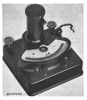
Fig. 11 Ballistisches Galvanometer
