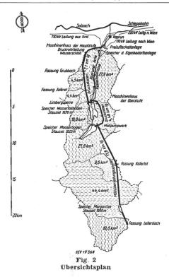
einen rund 12 km langen Stollen dem Stausee Mooserboden zugeführt wird. Ausserdem wird die Möglichkeit bestehen, mit allfälliger Überschussenergie Wasser aus dem Stausee Wasserfallboden nach Mooserboden zu pumpen. Die jährliche Energieproduktion der Kraftwerkgruppe ist auf rund 600 GWh berechnet worden, wovon 400 GWh im Winter.
