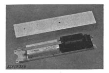
Parallel zum Netz ist ein Kondensator von 0,04 µF angeschlossen. Grundplatte und Deckel aus Aluminiumblech.
