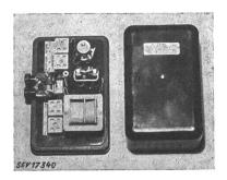
Trockengleichrichter, Widerstände zur Begrenzung des Ladestromes. Schutz durch 2 Kleinsicherungen. Gehäuse aus schwarzem Isolierpreßstoff für Wandmontage.
