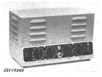
Ausgangsleistung. Eingangsübertrager und Programmwähltaste für T-R. Lautstärke- und Klangregler, Umschalter für Grammophon und Telephonrundspruch. Ausgangsübertrager mit 6 Anzapfungen. Netztransformator mit getrennten Wicklungen. Schutz durch 2 Kleinsicherungen. Einzelteile in Blechgehäuse eingebaut und mit verschraubtem Blechdeckel abgeschlossen.
