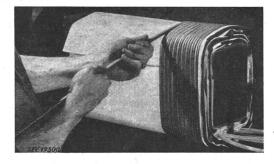
Fig. 3 Verwendung als Lagenisolation bei Trockentransformatoren
