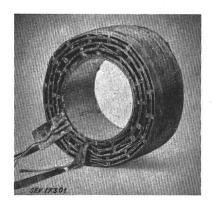
Fig. 4 Quinterraisolierte Spule eines Schweisstransformators
