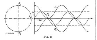
Die Ummagnetisierungskurven einzelner Punkte des rotierenden Ankers sind komplizierter Natur. Fig. 2 und 3 zeigen solche für Wechselfelder für Synchronismus (Fig. 2) und bei halbsynchroner Drehzahl (Fig. 3). Das mitlaufende Drehfeld magnetisiert einzelne Punkte des Ankerumfangs, wie die gestrichelten Linien zeigen; aber die Wirkung des invers rotierenden Feldes muss superponiert werden, so dass die resultierenden Ummagnetisierungs-
