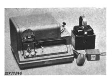
tor mit getrennten Wicklungen und sekundärseitig eingebauter Sicherung zur elektrischen Trennung und Anpassung an die Netzspannung. Handmikrophon mit eingebautem Schalter oder Tischmikrophon mit Fußschalter. Eingangsübertrager in separatem Blechgehäuse.
