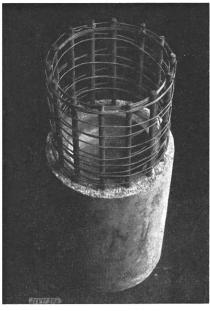
Fig. 2 Querschnitt durch Mast aus Schleuderbeton
