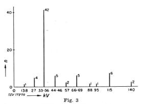
Verteilung der 1946 in Amerika insgesamt betriebenen 69 Löschspulen auf die verschiedenen Spannungen n Anzahl der Löschspulen
