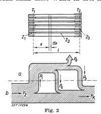
Energieflüsse im Thermoumformer Gebiet der elektrischen Energie Gebiet der thermischen Energie pro Zeiteinheit zufliessende Wärmemenge pro Zeiteinheit an das Kühlmittel abgegebene Wärme-
