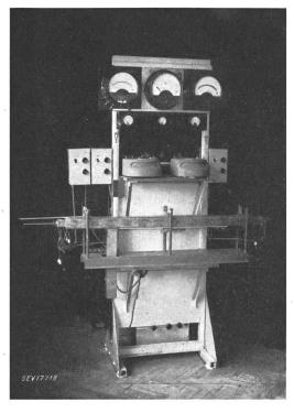
Fig. 3 Vorrichtung zur Messung von Impedanzen bis etwa 600 MHz
