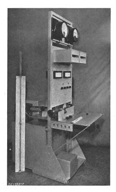
Fig. 2 Vorrichtung zur Messung der Verstärkereigenschaften von Elektronenröhren bis etwa 300 MHz
