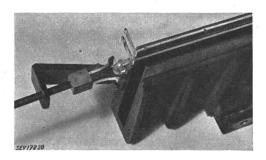
Fig. 4 Wellenleitervorrichtung zur Impedanzmessung bis etwa 1500 MHz
