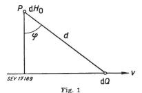
Feldstärke d $H_0$  im Punkt P, erzeugt durch die sich geradlinig mit der Geschwindigkeit v fortbewegende Elektrizitätsmenge dQ $\varphi$  Winkel zwischen der Verbindungsgeraden d und der Senkrechten von P auf die Bewegungsrichtung
