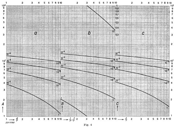
Kurvenblatt zur Ermittlung der Induktivitäten Bestimmung der Faktoren A, bzw. B und C der  $Gl.\ (14)$  und (24)
