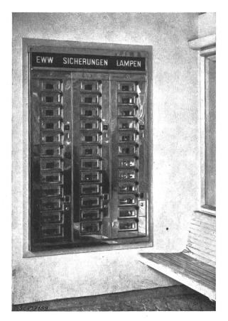
Fig. 1 Automat für Lampen und Sicherungen des EW Winterthur
