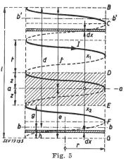
Darstellung einer einlagigen Zylinderspule
