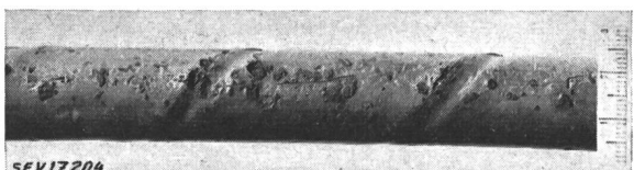
Fig. 4 Câble corrodé par du ciment
