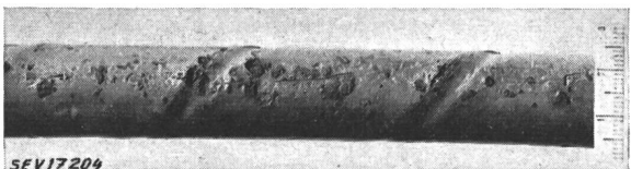
Fig. 4 Câble corrodé par du ciment
