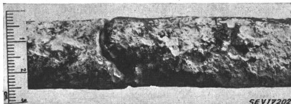
Fig. 2 Câble corrodé près d'un W-C
