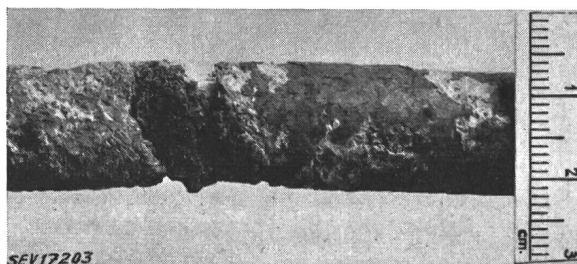
Fig. 3 Câble corrodé par les eaux d'écoulement d'une laiterie
