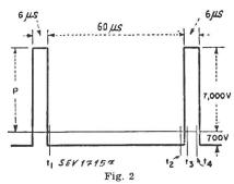
Wellenform des Strahlrücklauf-Impulses
