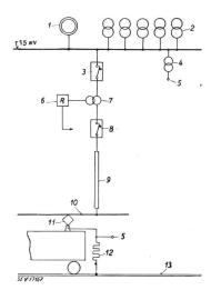
Fig. 3 Schaltschema für die Abschaltversuche im Unterwerk Seebach der SBB
