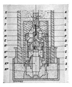
Fig. 1 Schnitt durch die Löscheinrichtung eines Ölstrahlschalters HPF 7 - 16% Hz
