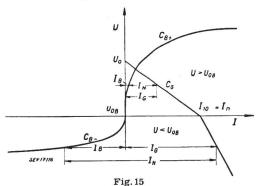
Caractéristique statique d'une génératrice à shunt magnétique marchant en tampon avec une batterie d'accumulateurs (courbe de principe)
