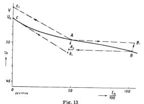
Caractéristique dynamique d'une génératrice à shunt magnétique (courbe de principe)
