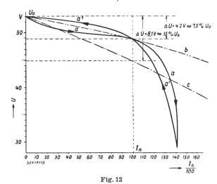
Caractéristiques statiques de génératrices à courant continu génératrice à shunt magnétique
