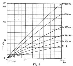
Caractéristiques dynamiques d'un accumulateur au plomb (t=0...1,5s)
