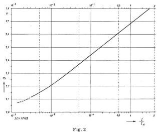
Tension aux bornes d'un accumulateur au plomb en fonction du courant de charge Etat de charge 100 %
