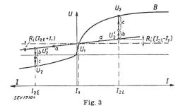
Caractéristique dynamique de l'accumulateur au plomb (Courbe de principe)
