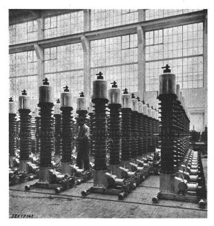
Fig. 3 Olarme Schalter 60 kV
