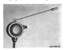
vieradrige Doppelschlauchschnur (3 P + E) mit den Motorklemmen verbunden. Bei Überhitzung des Motors betätigt der Temperaturfühler den Schalter. Dadurch wird die Magnetspule unsymmetrisch gespiesen, die Membrane gerät in Schwingung und erzeugt ein Signal. Dasselbe tritt bei Phasenunterbruch in einer Motorzuleitung ein.
