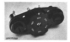
kopfes sind einpolige Klein-Sicherungselemente für Schmelzeinsätze  $5\times 20$  mm angebracht.
