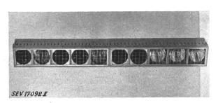
melschienen für 1 bis 4 Lampengruppen durch Hartpapierplatten isoliert. Anschlussklemmen mit Berührungsschutz und Befestigungsbride für das Bühnenkabel. Abmessungen für 10 Lampen: Höhe 300 mm. Breite 230 mm. Länge 2000 mm. Gewicht 18,7 kg.
