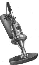
Staubsauger gemäss Abbildung. Zentrifugalgebläse, angetrieben durch ventilierten Einphasen-Seriemotor. Motoreisen vom Gehäuse isoliert. Der Apparat kann mit einer Führungsstange oder einem kurzen Handgriff ausgerüstet werden. Er ist in Verbindung mit verschiedenen Mundstücken, sowie einem Führungsrohr, zum Saugen-Blasen verwendbar. Apparatestecker 2 P eingebaut. Zuleitung Doppelschlauchschnur mit Stecker und Apparatesteckdose, Schalter in der letzteen eingebaut.
