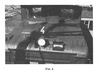
Rangierlokomotive mit Funkantenne und einer der an beiden Enden angeordneten Sprechstellen Schutzkasten geöffnet, Mikrotelephon auf Gabel liegend sichtbar
