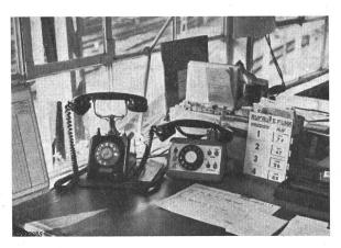
Fig. 5 Sprechstelle der Rangierfunkanlage auf dem Tisch des Aufsichtsbeamten im Hauptstellwerk
