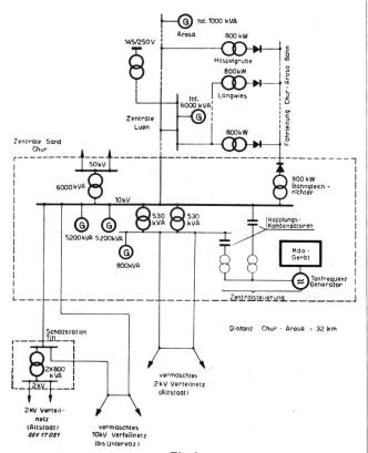
Fig. 1 Prinzipschema des Netzes der Licht- und Wasserwerke Chur
