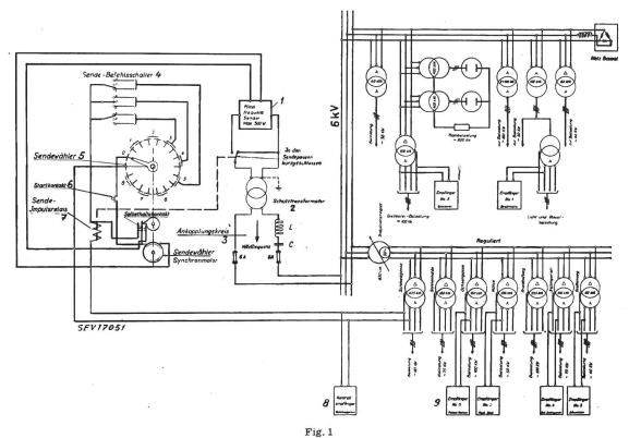
Vereinfachtes Schema der Netzkommandoanlage Riehen und des gesteuerten Netzes Links: Sendeanlage
