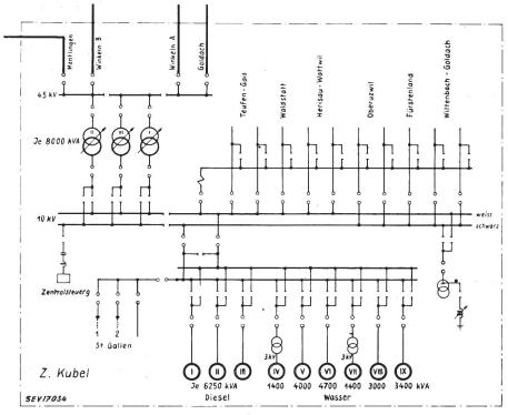
Fig. 2 Schaltschema des Kraftwerkes Kubel mit angeschlossener Tonfrequenz-Fernsteuerung
