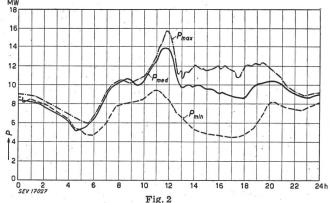
Belastungsverlauf des gesteuerten Netzes zur Zeit des Probebetriebes der Fernsteueranlage
