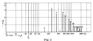
Analyse der höheren Harmonischen der Spannung des Netzes Riehen
