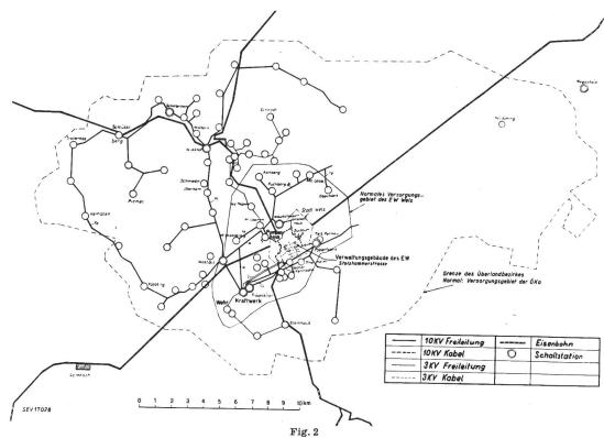
Hochspannungs-Leitungsnetz 3 und 10 kV des EW Wels
