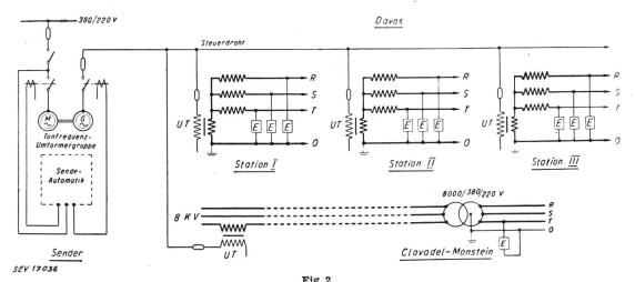
Prinzipschema der Fernsteueranlage Davos
