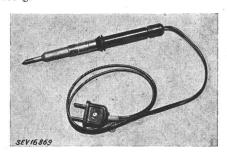
Der Lötkolben hat die Prüfung in sicherheitstechnischer Hinsicht bestanden.
