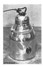
Staubsauger gemäss Abbildung. Zentrifugalgebläse angetrieben durch Einphasen-Seriemotor. Motoreisen vom Aussengehäuse isoliert. Apparat mit Schlauch, Führungsrohren und verschiedenen Mundstücken zum Saugen und Blasen ver-Kipphebelschalter wendbar. und Apparatestecker vorhanden. Zuleitung Gummiaderschnur mit Stecker und Apparatesteckdose.
