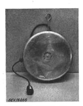
Zum Aufhängen bestimmte Kabelrolle aus Aluminium-blech, gemäss Abbildung, mit 15 m Doppelschlauchleiter 3 × 1 mm<sup>2</sup> und Kupplungs-steckdose 2 P + E. Selbsttätiges Aufwickeln des Kabels durch Rückzugfeder. Schleifkontakte bestehend aus Messingringen und Broncefedern mit Isolationen aus Hartpapier eingebaut. Metallgehäuse mit Erdungsader des Kabels verbunden.
