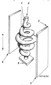
Fig. 11 «Spiral-Beam-Control»-Methode zur Frequenzmodulierung von Magnetrons
