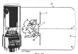
Fig. 10 Elektronenvervielfacher der RCA mit Beschleunigungselektrode
