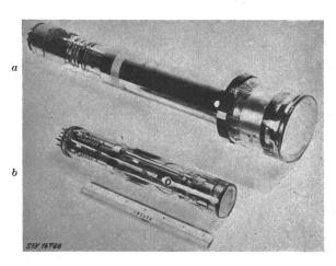
Fig. 8 Fernseh-Kameraröhren RCA-2P23 Image-Orthicon-Röhre «Mimo»-Kleinkameraröhre (RCA-2P22)
