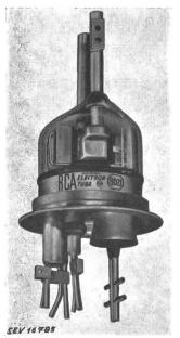
Fig. 5 6-kW-Sende-Doppeltetrode, RCA-8D21 Push-Pull-
