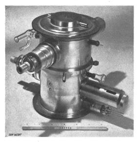
Fig. 17 1-kW-«Electron Coupler» für 800 MHz
