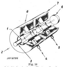
Schnitt durch einen «Electron Coupler»
