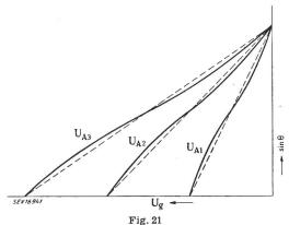
öffnungswinkel in Funktion der Gitterspannung für verschiedene Anodenspannungen einer Triode zur Strahlerzeugung [19]
