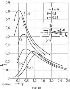
Strahlstrom pro Raumwinkel in Funktion des Abstandes Kathode-Gitter [18]
