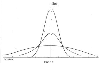
Stromdichteverteilung in der Überkreuzungsebene S(r) Stromdichte Abstand von der Symmetrieachse z Parameter: Kathodentemperatur
