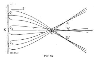
Zwischenbild und Überkreuzung (cross over) im Triodenteil eines strahlerzeugenden Systems
