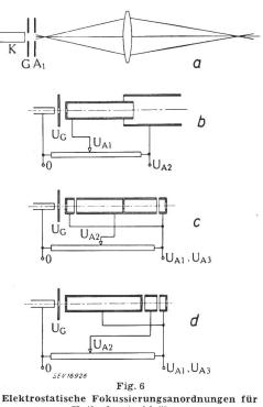
Kathodenstrahlröhren  $U_{\mathtt{A1}}$  ,  $U_{\mathtt{A2}}$  ,  $U_{\mathtt{A3}}$  Anodenspannungen Gitterspannung
