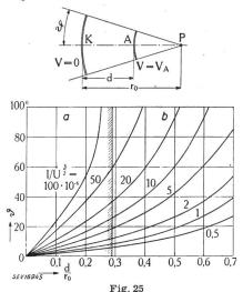
Strahlerzeugendes System nach Pierce Zusammenhang zwischen Strahlstrom, Anodenspannung und Abstand Kathode—Anode [22] 9 halber Kathodenwinkel Weitere Legenden siehe Fig. 24
