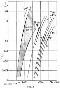
Spezifische Emission von Glühkathoden in Funktion der Temperatur
