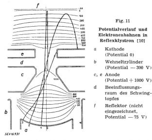
oben befindet sich die negativ gegen die Kathode vorgespannte Elektrode des Elektronenspiegels, der die Elektronen zur Umkehr zwingt, so dass sie nochmals den Schwingtopf passieren müssen. In Fig. 11 sind für drei verschiedene Ausgangspunkte auf der Kathode die graphisch ermittelten Elektronenbahnen eingezeichnet [10].
