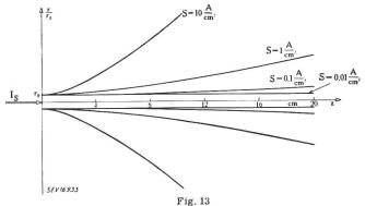
Zerstreuung eines Elektronenstrahls durch eigene Raumladung bei verschiedenen Stromdichten
