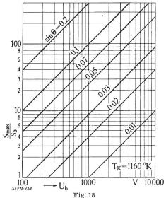
Maximal erreichbare Stromdichten in der Überkreuzungsebene und in der Bildebene [17]
