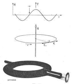
Fig. 26 Wirkungsweise des Betatrons Induzierte elektrische Feldstärke Magnetische Feldstärke Kraft, die das Elektron beschleunigt Umlaufsrichtung des Elektrons
