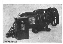
sator angeschlossen. Kondensator und Schalter in Blechgehäuse. Verbindungsleitungen zwischen Motor und Schalter in Metallschlauch. Zuleitung dreiadrige Gummiaderschnur mit 2 P + E-Stecker.
