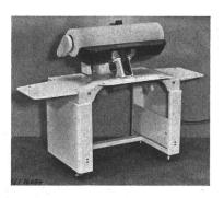
Blech. Motor auf Gummi gelagert. Einstellbarer Temperaturregler, sowie zwei einpolige Schalter für Motor und Heizung und eine Signallampe eingebaut. Ein- und Auskuppeln, sowie das Anpressen der Bügelrolle erfolgt durch zwei Hebel. Zuleitung dreiadrige Gummiaderschnur mit 2 P + E-Stecker fest angeschlossen. Gewicht 53 kg.
