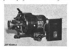
dungsleitungen zwischen Motor und Schalter in Metallschlauch. Zuleitung vieradrige Gummiaderschnur mit 3 P + E-Stecker.
