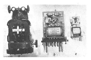
Fig. 12 Polarisierte Relais hoher Empfindlichkeit
