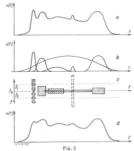
Aufbau eines beliebigen zeitlichen Vorganges durch Fundamentalimpulse
