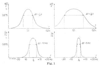
Glockenförmige Impulse verschiedener effektiver Zeitdauer mit zugehörigem Frequenzspektrum
