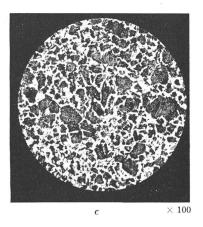
Mikrogefüge des Rotorstahles mit 3 % Ni a; b; c wie bei Fig. 3
