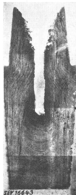
Fig. 6 Saugtrichter eines im Sand abgegossenen Stahlblockes (Baumannabdruck)
