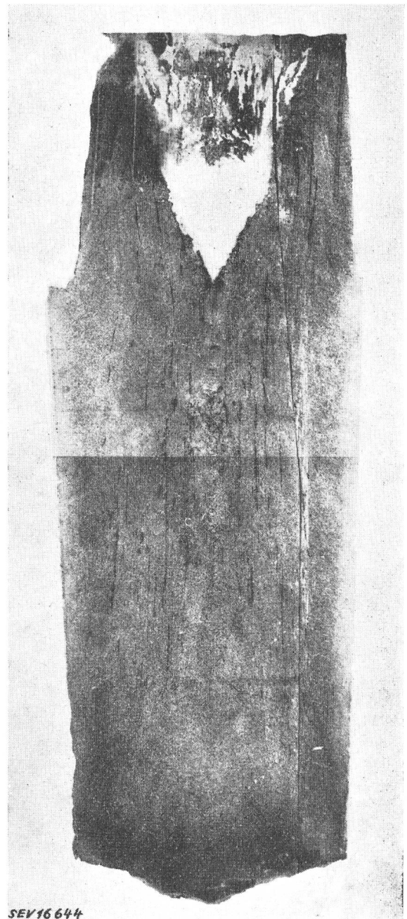
Fig. 7 Im Guss eingeschlossene «Seigerungen» (Baumannabdruck)
