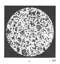
$${\rm Fig.}~3$$  Mikrogefüge des Rotorstahles mit 0,5 % Cr, 1,5 % Ni
