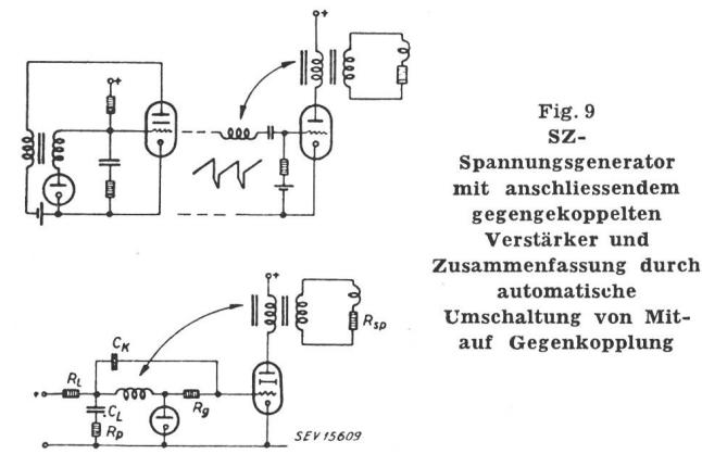
Man könnte nun daran denken, die Ablenkspule unmittelbar in den Anodenkreis des Generators zu legen. Aus Nebengründen (technologische Gründe und Fragen der gegenseitigen Beeinflussung von Vertikal- und Horizontal-Ablenkung) ist man daran interessiert, die Spule über einen Transformator zu speisen. Um den Transformator klein zu halten, muss man den Magnetisierungsstrom aufbringen und benötigt daher einen
