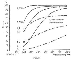
Verlauf der Strommodulation in Funktion der Beschleunigungsspannung
