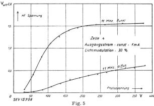
Ausgangswechselspannung am Vervielfacher in Funktion der Photospannung
