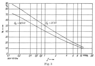
Frequenzgang der Modulationsfähigkeit bei verschiedenen Anodenspannungen (fokussiert) M Modulationsfähigkeit
