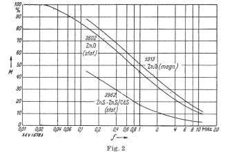
Frequenzgang der Modulationsfähigkeit 25 kV Modulationsfähigkeit
