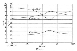
Abhängigkeit der Modulationsfähigkeit und des Gleichlichtes von der Elektronenlinsenspannung
