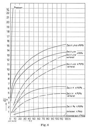
Quellung  $\frac{\triangle h}{h}$  verschiedener Schichtstoffe in Funktion der Zeit t des Aufenthaltes der Stoffe in Wasser
