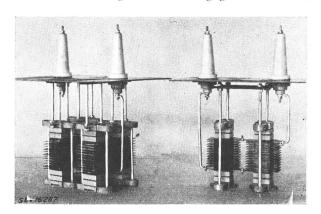
Fig. 15 Kondensatoren mit Durchführungen und Stützplatten aus Rastea (Hochfrequenz-Steatit)
