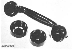
Fig. 4 Mikrotelephon der Tischstation aus Isolierpreßstoff
