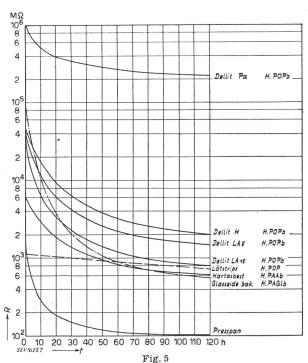
Widerstand R im Innern verschiedener Schichtstoffe in Funktion der Zeit t des Aufenthaltes der Stoffe in Luft von 80 % relativer Feuchtigkeit
