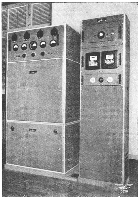
Fig. 1 Einer der Peravia-Sender für den Nahzonenverkehr des Flugplatzes Zürich-Kloten Neben dem Sender befindet sich der Empfangssatz für die Fernsteuerung vom Flugplatz aus
