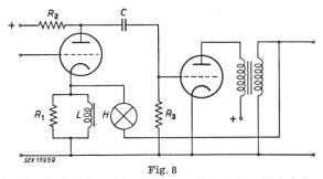
Verzögerte Regelung durch Verwendung eines Heissleiters Prinzipschema
