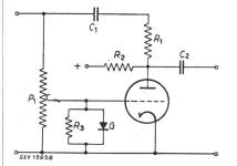
als Teilwiderstand eines Spannungsteilers Prinzipschema
