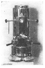
Kaffeemaschine gemäss Abbildung, mit vom Wasser isolierten Heizelementen. Wasserbehälter ohne Wärmeisolation. Der Inhalt wird durch Heizelemente und einen Druckregler unter Druck auf Temperaturen über 100 °C gehalten. Armaturen Kaffeezubereitung Heisswasserund Dampfentnahme, ferner Sicherheitsventile. Wasserstandanzeiger, Manometer und Sicherheitsvorrichtung gegen Überhitzung vorhanden. Druckregler wird ausserhalb der Maschine montiert. Anschlussklemmen auf keramischem Ma-
