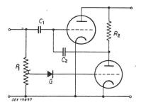
Fig. 6 Schaltung mit Röhre als variablem Gegenkopplungswiderstand Prinzipschema
