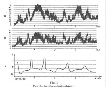
Pegelschreiber-Aufnahme eines Klaviersolos gleiche Aufnahe nach erfolgter Dynamikkompression Kurve der Regelspannung. Einstellung des Potentiometers: stark aufgedreht; II in Mittelstellung; III stark eingedreht
