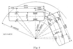
Stellung des Anhängerzuges in enger Kurve (Maßskizze des Anhängerzuges der Fig. 5)
