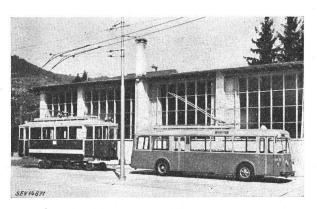
Fig. 8 Trolleybus-Anhängerzug mit Transportschemel der Rheintalischen Strassenbahnen
