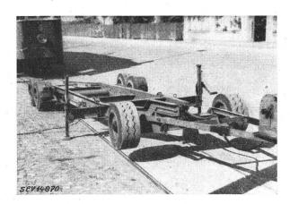
Fig. 7 **Strassentransportschemel der Rheintalischen Strassenbahnen** Tragkraft 12 t, in gehobener Stellung zur Auffahrt mit dem Tramwagen bereit
