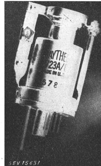
Fig. 2 Klystron elektronische Laufzeitöhre zur Erzeugung von Zentimeterwellen
