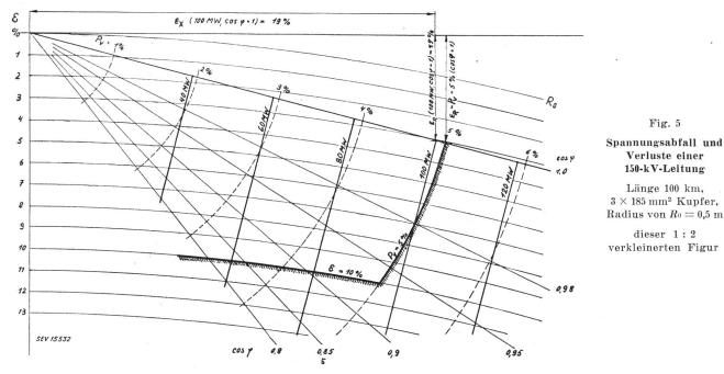
abfallgeraden für  $\cos \varphi = 1$  durch Schnitt mit den entsprechenden Werten der Skala des ohmschen Widerstandes gefunden werden (Fig. 4).
