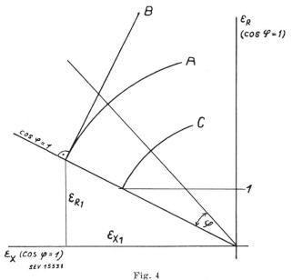
Geometrischer Ort des Spannungsabfalls für die Einheitswerte der Leistung (A Scheinleistung, B Wirkleistung) und der Verluste (C)
