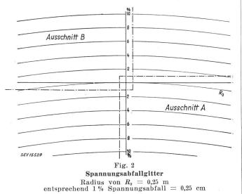
Fall 1 m (in Fig. 2 ist wegen der Verkleinerung  $1:4\ R_0=0.25\ \mathrm{m}$  und entsprechend 1%0 Spannungsabfall = 0.25 cm). Für bestimmte Belastungsfälle (nur eine Energierichtung) werden Ausschnitte des Gitters verwendet, und zwar für Anfangsspannung  $U_a=$  konstant Ausschnitt A, Endspannung  $U_e=$  konstant Ausschnitt B (Fig. 2). Es empfiehlt sich, die Gitter als Pause zur Herstellung von Heliographien anzufertigen und diese als Formulare zum Einzeichnen zu verwenden.
