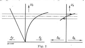
Strom-Spannungscharakteristik eines Parallelkreises  $I_2$ c kapazitiver Blindstrom;  $I_{2\perp}$  induktiver Blindstrom;  $-\cdot -\cdot$  Resonanzstelle
