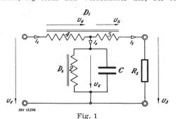
Schema eines magnetischen Stabilisators Erläuterungen im Text
