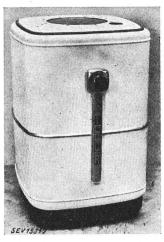
Maschine gemäss Abbildung, zum Waschen und Zentrifugieren von Wäsche und zum Spülen von Geschirr. Antrieb durch ventilierten Einphasen-Kurzschlussankermotor mit Hilfsphase und Zentrifugalschalter. Wäschetrommel mit Rührwerk und Abwaschvorrichtung auswechselbar. Dreiadrige Zuleitung mit 2 P + E — Stecker fest angeschlossen.
