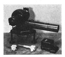
des angebauten Zündtransformators geerdet. Netzanschluss und Erdungsklemmen hinten an Brennergehäuse. Die Steuerung erfolgt durch Schaltapparate LANDIS & GYR: Schaltautomat Typ RD 20 1, Kaminthermostat Typ TK2, Kesselthermostat Typ TTBv/12.
