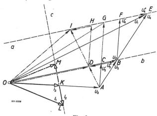
Fig. 3 Vektordiagramm der Teilspannungen eines magnetischen Stabilisators
