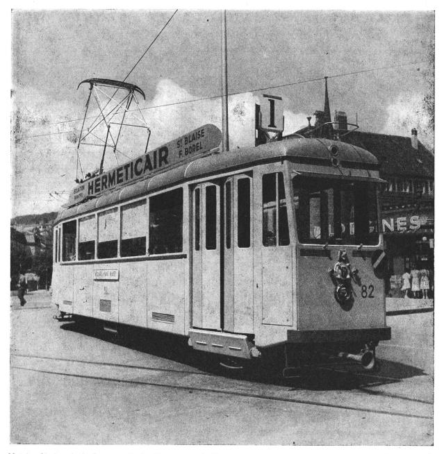
Motrice légère de la Compagnie des Tramways de Neuchâtel. Puissance 200 ch, vitesse maximum 60 km/h
