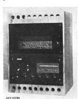
16...51 m, 200...600 m und 750...2000 m. Niederfrequenzverstärker auf separatem Chassis für Telephonrundspruch, Grammophon- und Mikrophonverstärkung.
