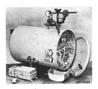
Steuerung durch Druckregler und dreipoliges Schaltschütz. Sicherheitsvorrichtung am Flansch angebracht, welche bei Überhitzung die Sicherungen durch Kurzschliessen der Zuleitungen zum Durchschmelzen bringt.
