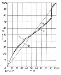
Fig. 5 Spannungsverteilung an der Aussenfläche eines Stützers Typ K
