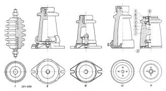
Fig. 1 Verschiedene Stützer-Bauarten
