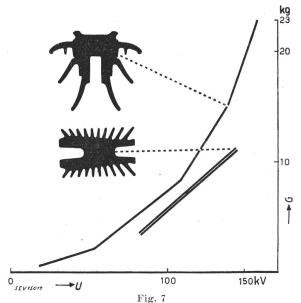
Vergleich des Gewichtes (G) eines Glockenisolators und eines Zapfenisolators in Funktion der Regenüberschlagspannung (U)
