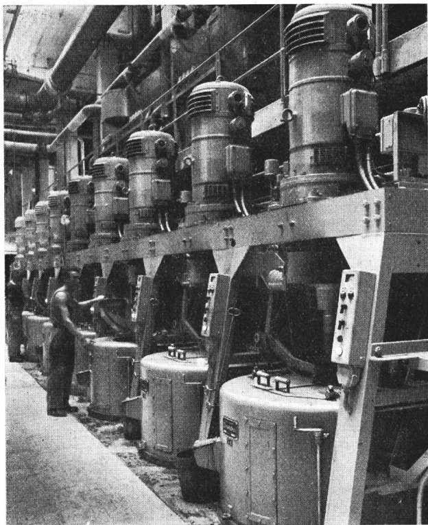
Fig. 2 Glasisolierte Hochleistungszentrifugen in der Zuckerfabrik Aarberg
