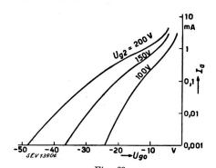
Fig. 33 Kennlinien einer Regelpenthode für verschiedene Schirmgitterspannungen
