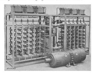
Fig. 2 Gleichrichteranlage für 24 V, 350 A
