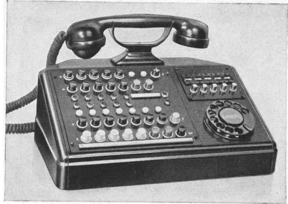
Fig. 2 5teilige ferngesteuerte Vermittlungsstation
