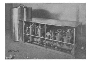
Fig. 11 «Megafroster»-Tiefkühlapparat
