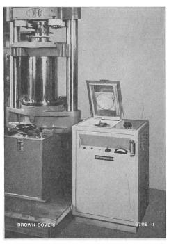
Fig. 2 Hochfrequenz-Röhrengenerator
