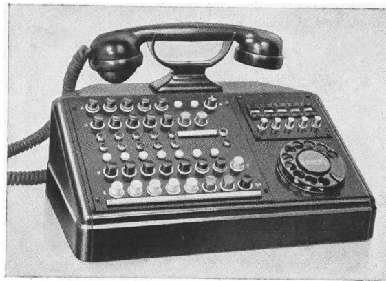
Fig. 2 5teilige ferngesteuerte Vermittlungsstation
