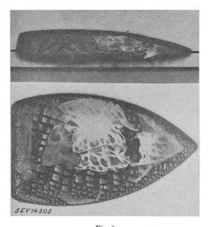
Fig. 9 Verkohlung eines Bügelbrettes aus Holz mit Ueberzug durch ein Regler-Bügeleisen nach 30tägiger Dauerbelastung bei höchster Reglerstellung
