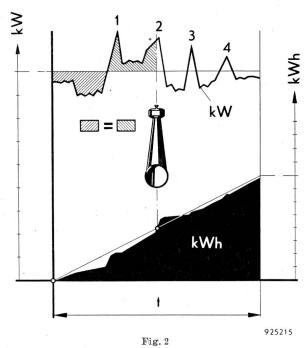
Darstellung der Wirkungsweise des Sollastkontrollzählers «Duomax»
