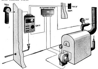
Fig. 1 Equithermisch gesteuerte Oelheizung
