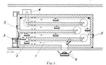
Verkürzter Tunnel-Backofen mit mehreren Etagen
