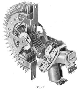
Motorwähler (Drehgeschwindigkeit 200 Schritte pro Sekunde)
