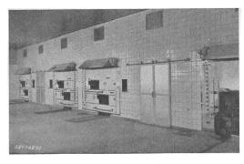
Fig. 2b Auszug-Backofen (rechts) und Einschiessöfen (links)
