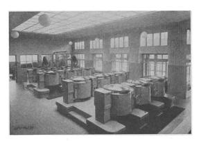
Fig. 6 Elektrische Volksküche mit 12 Elektroden-Kochkesseln zu 500 Lit.
