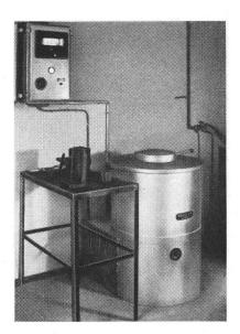
Fig. 2 Elektrischer Goldschmelzofen Höchsttemperatur 1250° C
