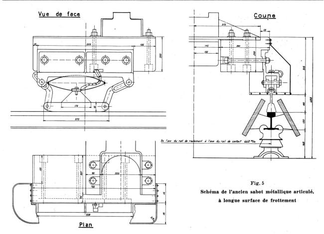
acier en forme de palette; il presse la surface du rail de contact par la force d'un ressort à course limitée. Un levier muni d'une poignée isolée permet au personnel de le mettre en service ou hors service par sa rotation d'un quart de tour autour de son support. Chacun des 4 dispositifs d'une automotrice dépendant d'une boîte d'essieu est double, comme l'indique la fig. 3; bien qu'un seul soit régulièrement en service, l'expérience a montré, d'une part, que
