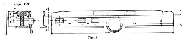
Eclissage d'un joint de dilatation du rail de contact
