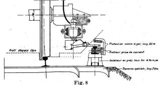
Nouveau frotteur, permettant une protection supérieure du rail de contact
