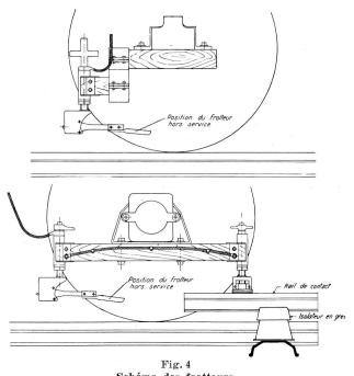
Schéma des frotteurs Ils sont montés sur une traverse isolante en bois (l'un en service et l'autre replié).
