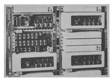
Hauptsache aus einem Telephonometer, einer Spezialuhr, wie sie damals in den Fernämtern von den Telephonistinnen in grosser Zahl zur Messung der Gesprächsdauer bei Fernverbindungen verwendet wurde. Da im automatischen Netzgruppenverkehr der Aufzug und die Ingangsetzung des Uhrwerkes nicht mehr manuell erfolgen konnten, wurde diese Arbeit den beiden, im Bilde gut sichtbaren Elektro-
