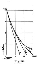
Fig. 26 stellt den Verlauf der Amplituden der Temperaturschwingungen innerhalb der Mauer dar, wobei diese Schwingungen bis auf den Wert Null an den Innenflächen abklingen, gemäss den getroffenen Annahmen, wonach diese konstante Temperatur aufweisen sollen.
