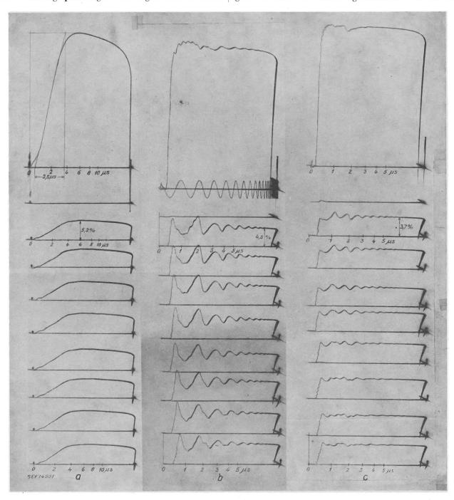
Fig. 16 Oszillogramme der Windungsspannungen an einer Polspule Oben: Oszillogramm der Stoßspannung  $U_{\rm A}$ .
