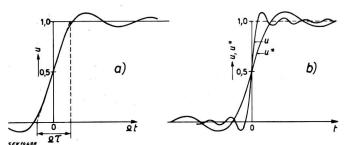
Darstellung der Integralsinusfunktion  $u = \frac{U}{2} + \frac{U}{\pi} \int_{0}^{\Omega} \frac{\sin \omega \ t}{\omega} \ \mathrm{d}\omega$
