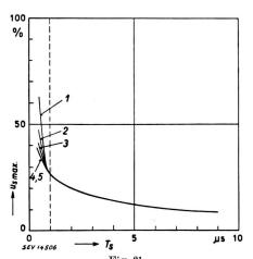
Fig. 21 Maximalwerte der Spulenspannungen in einer Generatorwicklung
