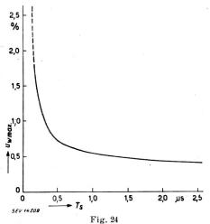
Maximalwerte der Windungsspannungen in einer Transformatorwicklung
