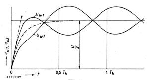
$\begin{array}{c} {\rm Fig.~6} \\ {\rm Windungsspannung~einer~Zweiwindungsspule} \\ (T/T_{\rm k}=0,1) \\ {\rm Bezeichnungen~wie~in~Fig.~4} \end{array}$
