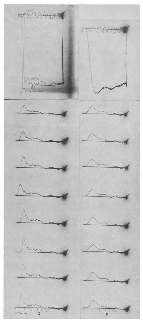
waren 0,5, 1,2, 2,8 u. 8,7  $\mu$ s. Man sieht, dass die Windungsspannungen in jeder Spule ungefähr gleich gross sind. Die Höhe der Windungsspannungen hängt aber
