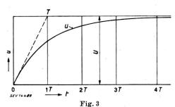
Stoßspannung mit exponentiellem Anstieg u Stoßspannung, gemessen zwischen Anfang und Ende der Wicklung; U Maximalspannung; T Zeitkonstante; t Zeit.
