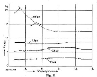
Maximalwerte der Windungsspannungen an den Eingangsspulen eines Generators
