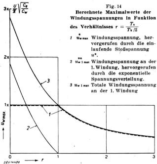
Fig. 14 zeigt diese beiden Windungsspannungen in Abhängigkeit vom Verhältnis  $r=\frac{T_s}{T_b/2}$ . Die Or-
