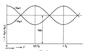
Fig. 7 Windungsspannungen einer Zweiwindungsspule (T=0) Bezeichnungen wie in Fig. 4
