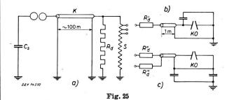
Schaltungen für die Spannungsmessungen
