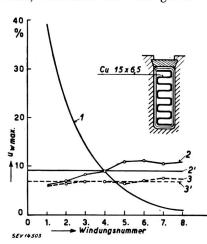
Fig. 18 Maximalwerte der Windungsspannungen an Eingangsspule eines Generators  $u_{\text{w max}}$  Windungsspannungs - Maximalwert in % der angelegten Stoßspannung; berechnete Werte bei Rechteckstoss  $(T_s = 0);$  2 Messwerte bei Stirnzeit  $T_s = 0.5 \ \mu s; 3 \ \text{Mess-}$ werte bei Stirnzeit = 1,1  $\mu_{i}$ s; 2' Mittelwerte der 8 Windungen; oben: Skizze der untersuchten Wicklung.
