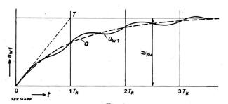
Fig. 4 Zeitlicher Verlauf der Windungsspannung der ersten Windung (für den Fall  $T/T_{\rm k}=1$ )
