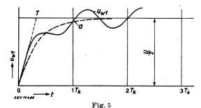
Zeitlicher Verlauf der Windungsspannung der ersten Windung (für den Fall  $T/T_k = \frac{1}{2}$ )
