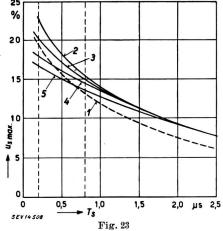
Maximalwerte der Spulenspannungen in einer Transformatorenwicklung
