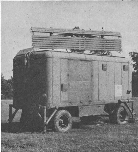
Fig. 4 Radaranlage mit Antennensystem zur Abtastung verschiedener Höhensektoren
