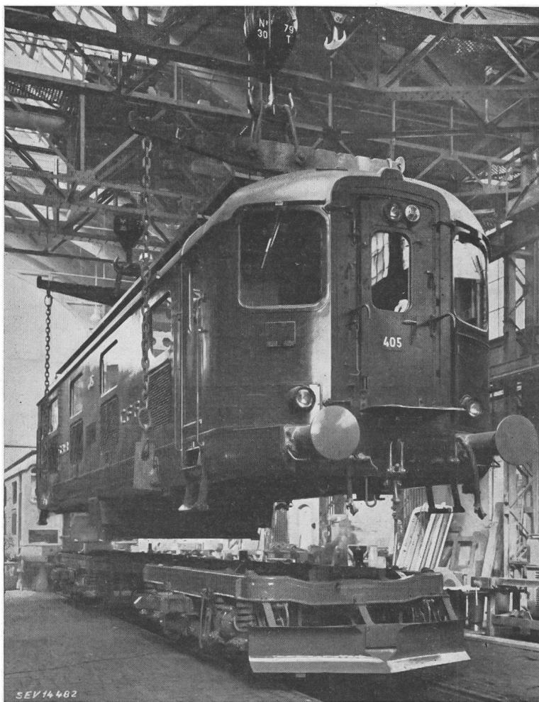
Zusammenbau der SBB-Leichtschnellzugs-Lokomotive Re 4/4
