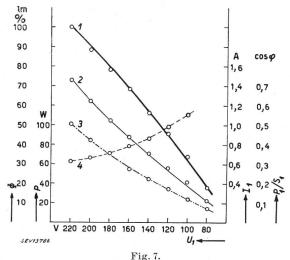
Charakteristiken einer Hochspannungs-Fluoreszenzröhre
