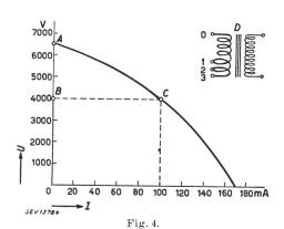
Strom-Spannungs-Charakteristik eines Streufeldtransformators zur Speisung von Hochspannungs-Fluoreszenzröhren
