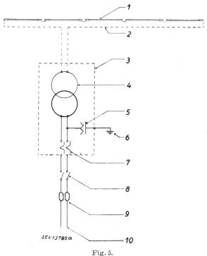
Prinzipschema einer Hochspannungs-Fluoreszenzröhren-Anlage
