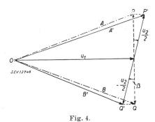
Vektorielle Darstellung der Spannungsverhältnisse beim Phasensprung-Diskriminator
