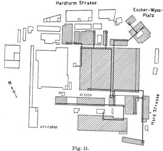
Lageplan nach der Vereinheitlichung des Heizsystems Die schraffierten Gebäude werden aus der neuen Wärmezentrale mit Grundwasser-Wärmepumpe gespeist
