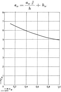
Fig. 6. Mittlere Leistungsziffern  $\varepsilon_m$  in Abhängigkeit der Leistungsaufteilung  $n_w$
