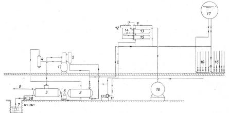
Fig. 12. Schema der Wärmepumpenheizung bei Escher Wyss Kompressor
