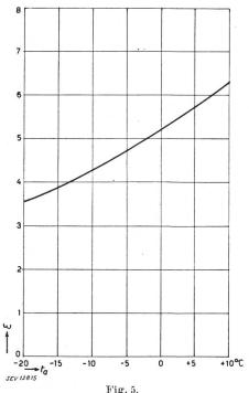
Leistungsziffern ε in Abhängigkeit der Aussentemperaturen ta (auf Grund von Fig. 4)
