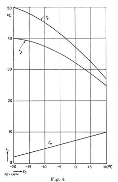
Heizwassertemperaturen t in Abhängigkeit der Aussentemperaturen  $t_a$  für eine Deckenheizung
