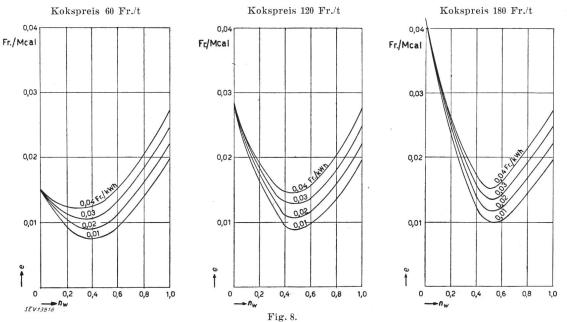
Wärmekosten e beim kombinierten System für verschiedene Brennstoffkosten (gültig für aw = 350 Fr./Meal/h) in Funktion des Leistungsanteils der Wärmepumpe nw
