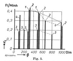
Mittlere Lichtausbeute  $\eta$  in Dlm/W und Lampenkosten  $K_{\mathsf{L}}$  pro Mlmh verschiedener Lampentypen, abhängig vom Nennlichtstrom  $\Phi$
