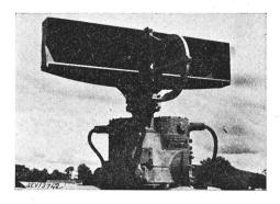
Fig. 2. Reflektor der 3-cm-Radar-Anlage
