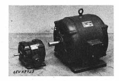
Beschreibung: Offene, ventilierte Drehstrom-Kurzschlussankermotoren mit Kugellagern, gemäss Abbildung. Sechs Enden der aus Kupfer bestehenden Statorwicklung auf seitlich angebrachte, durch verschraubten Deckel geschützte Klemmenplatte geführt (Stern- oder Dreieckschaltung). Erdungsklemme vorhanden.
