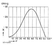
Fig. 5. Erforderliches zusätzliches Drehmoment M in Funktion der Läuferstellung α zur Erreichung einer linearen Regelcharakteristik
