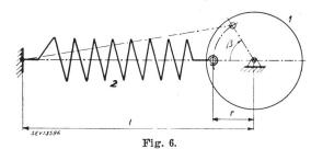
Vorrichtang mit Feder (2) und Exzenter (1) zur Erzeugung eines zusätzlichen Drehmomentes
