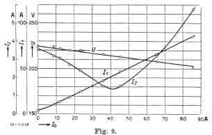
Charakteristiken des Dreiphasen-Induktionsreglers mit zusätzlichem Feder-Drehmoment
