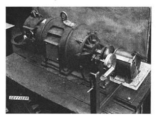
Fig. 8. Versuchsanordnung des Dreiphasen-Induktionsreglers
