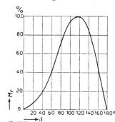
Fig. 7. Drehmoment-Charakteristik des Federsystems nach Fig. 6
