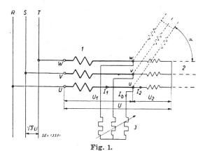
Schema des Dreiphasen-Induktionsreglers als Compound-Transformator
