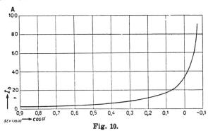
Abhängigkeit des Verdrehungswinkels  $\alpha$  des freigelassenen Läufers vom Belastungsstrom  $I_b$  (berechnete Werte nach Gleichung (15))  $U_2 = 200 \text{ V (konstant)}$  oos  $\varphi = 1$
